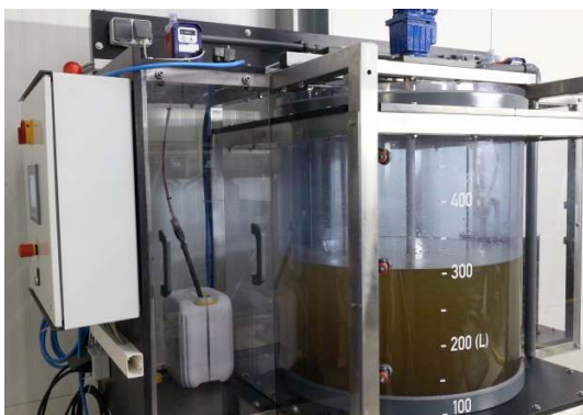
Moduł do eliminacji fosforu, reaktor 500 litrów, pojemność lejki sedymentacyjnej około 50 litrów
