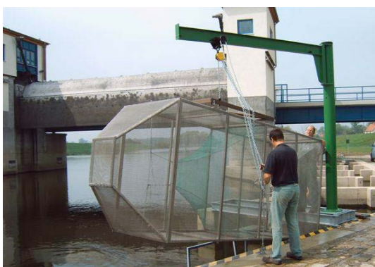
u góry: Specjalny więcierz do kwantyfikacji wędrówek młodych węgorzy, stosowany na dolnej Haweli
