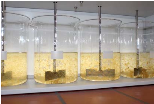
Próby strącania, flokulacji i sedymentacji w laboratorium IfB
