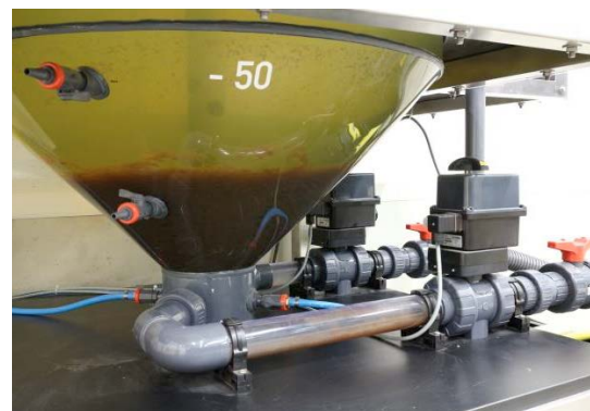
Moduł do eliminacji fosforu, reaktor 500 litrów, pojemność lejki sedymentacyjnej około 50 litrów
