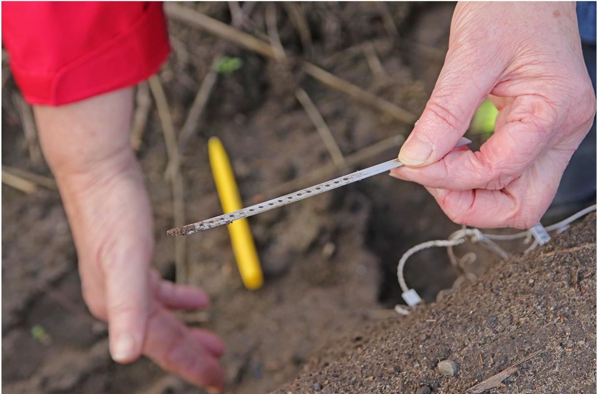
Der Bait-Lamina Test: Die Anzahl der ausgefressenen Löcher erlaubt Rückschlüsse auf das Bodenleben.
