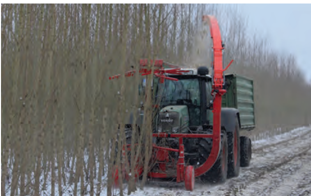
Abb. 3.16: Anbau-Mähhackler bei der Pappelernte (Prototyp eines ATB/JENZ-Hacker für 1-reihige Bestände)
