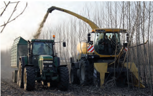
Abb. 3.14: Feldhäcksler mit Gehölzschneidwerk bei der Pappelernte
