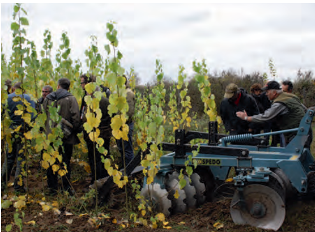
Abb. 5.44: Großes Interesse fand bei einer Exkursion im Oktober 2012 eine speziell für die Pflege von KUP entwickelte Scheibenegge
