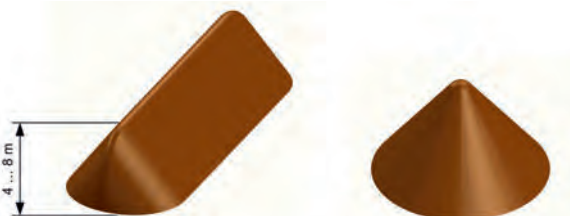
Abb. 3.19: Günstige Gestaltung von Freihäufen für die Lagerung von Hackschnitzeln
