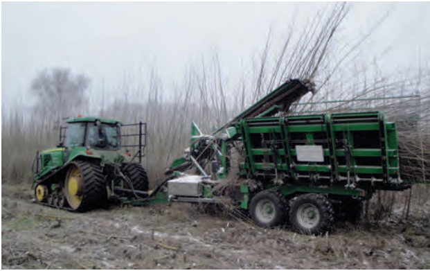
Abb. 3.13: Traktorgezogener Mähssammler zur Rutenernte (Stemster)
