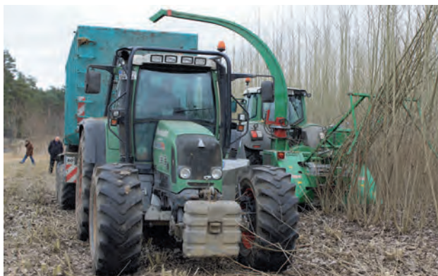
Abb. 3.15: Anbau-Mähhackler für Schlepper mit Rückwärtsfahreinrichtung bei der Pappelernte (für 1- und 2-reihige Bestände, Schmidt/JENZ-Hacker GMHT 140)
