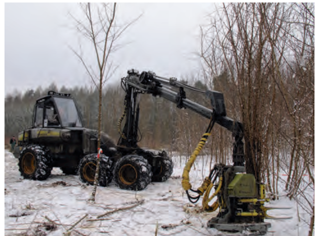
Abb. 5.33: Beerntung des vierjährigen Aufwuchses mit BRACKE C 16.b Fällerbündler Aggregat, hier zur Freistellung von Zukunftsbäumen („Lassreiteln“)
