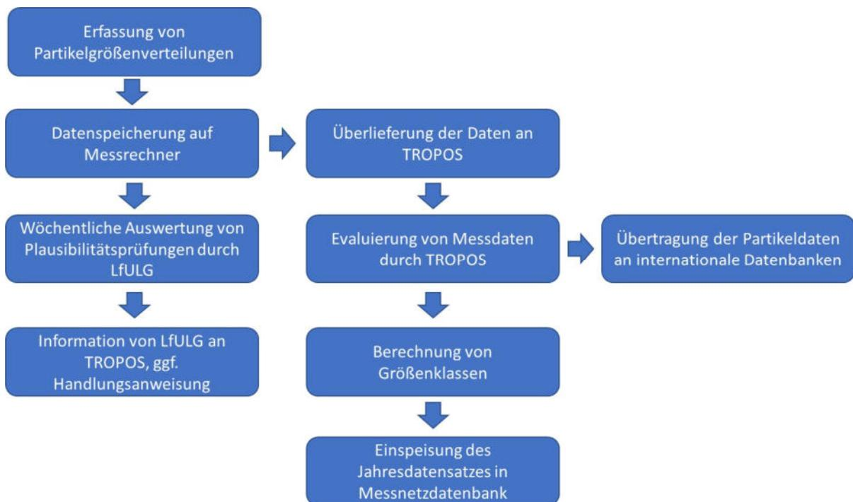
**Abb. 88:** Schema der Datenprozessierung am Beispiel des Luftgütemessnetzes Sachsen.
