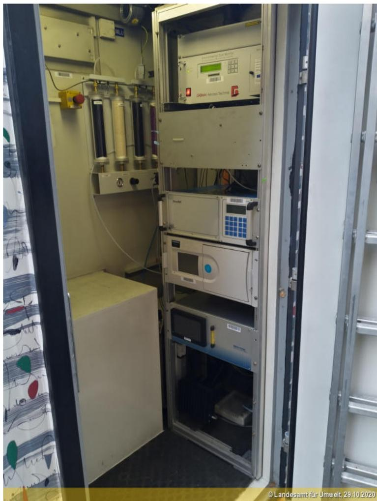
**Abb. 74:** Innenansicht des Messcontainers mit seinen Messgeräten an Verkehrsmessstellen des LfU im Land Brandenburg, Quelle: LfU.
