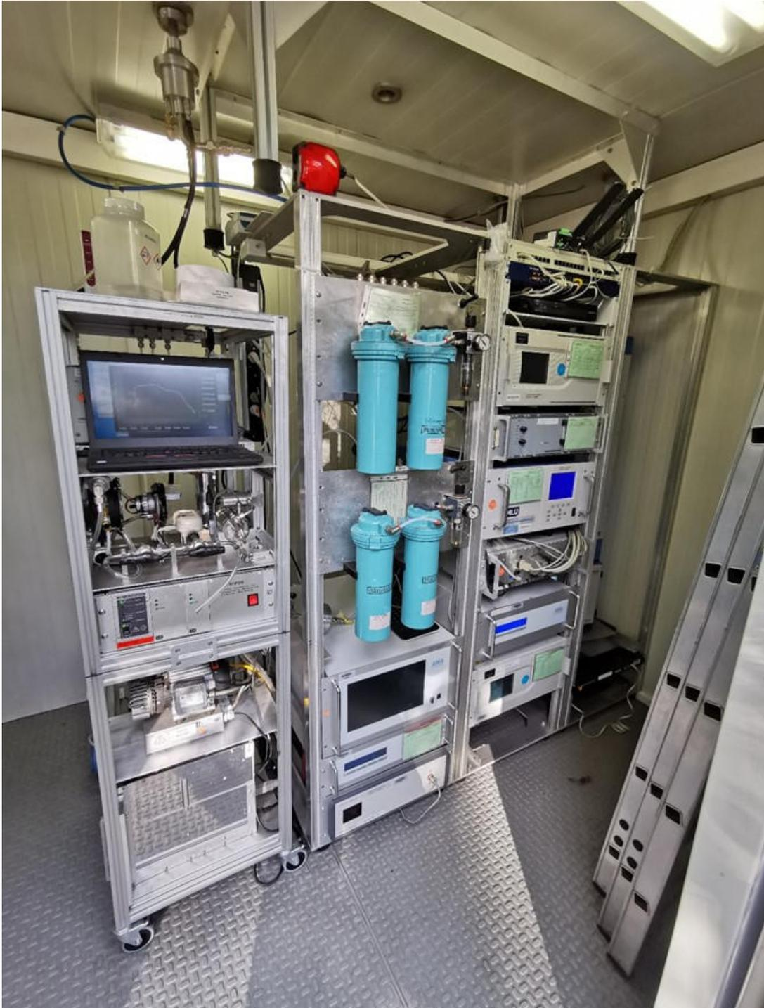
**Abb. 86:** Beispiel eines TROPOS Größenspektrometers im Luftgütemessnetz Sachsen in der Messstation Leipzig-Mitte.
