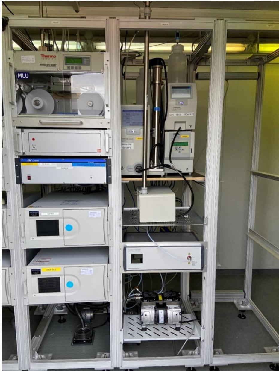
**Abb. 89:** Beispiel eines TSI Größenspektrometers mit zusätzlichem Partikelzähler zur Qualitätssicherung im Luftgütemessnetz Hessen, Quelle: HLNUG.
