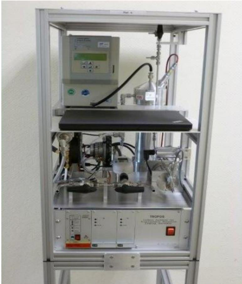
**Abb. 85:** Aktuelle Version eines TROPOS-Größenspektrometers.
