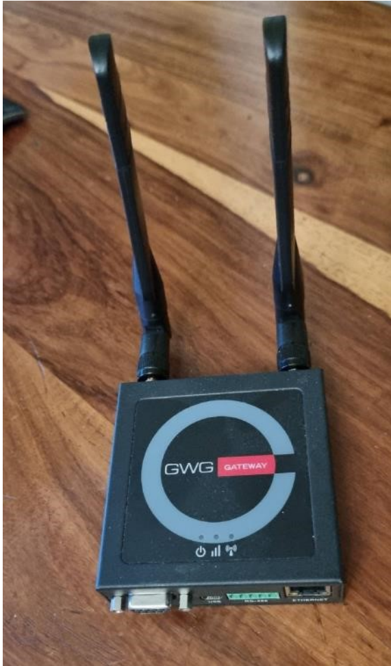
Abbildung 11: GSM-Router zum Betreiben einer LAN-Kamera (Ethernetstecker rechts). Stromversorgung über 12 Volt (Foto: Dr. Jörg Melzheimer)
