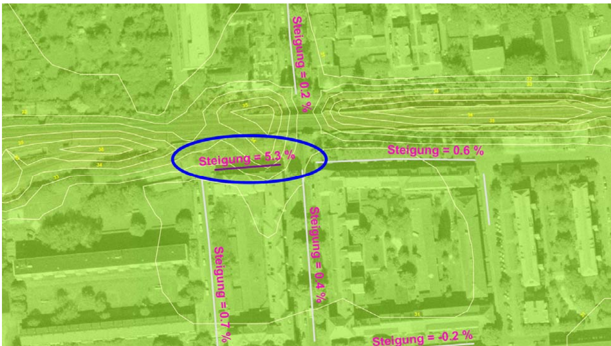
Abbildung 5-8: Längsneigung einer dammparallelen Straße
