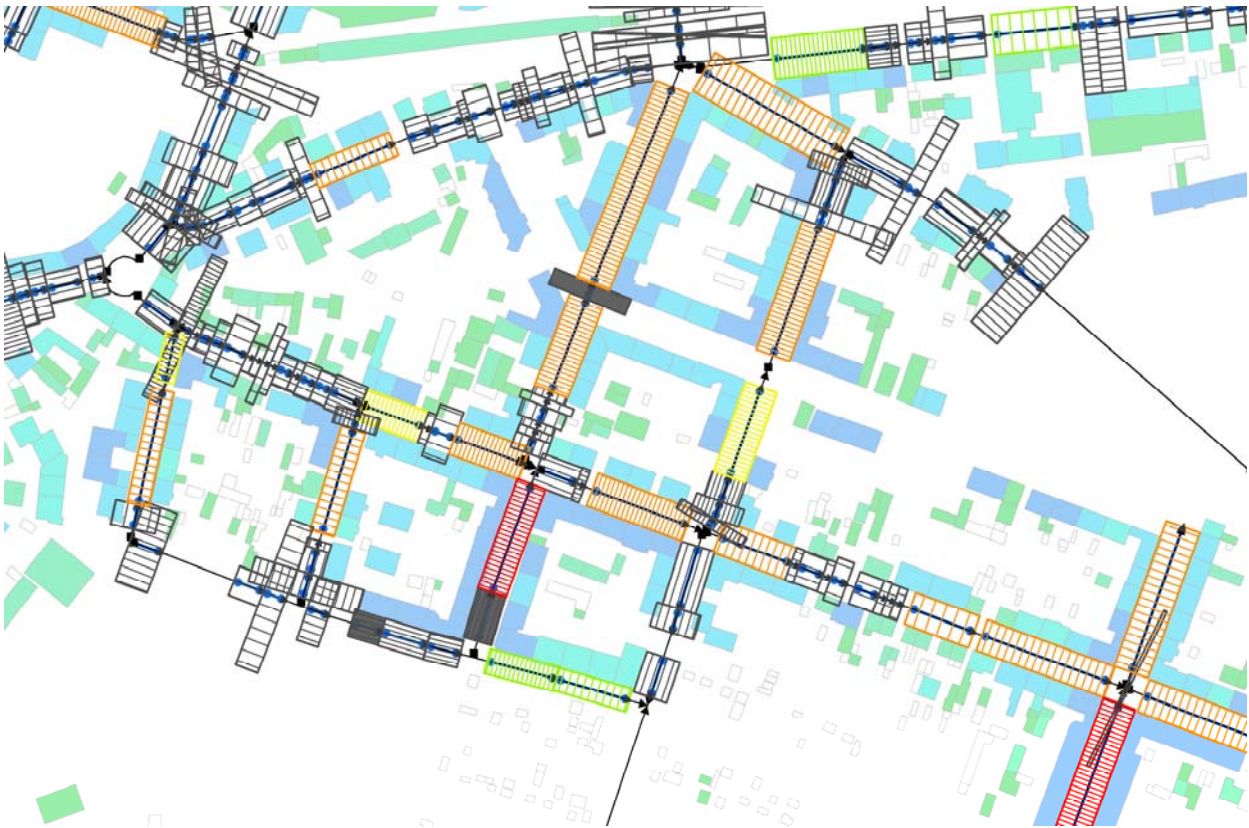
Abbildung 5-1: Darstellung von Teilabschnitten als Ergebnis der IMMIS build -Teilabschnittserstellung (grau schraffierte Flächen: zu kurze Teilabschnitte; bunte schraffierte Flächen: Teilabschnitte, die bereits dem Längen-Breiten-Kriterium vom IMMIS luft entsprechen, Farbe der Schraffur steht für die Porosität (grün hohe Porosität, rot geringe Porosität); blau-grüne Flächen in Vollfarbe: Gebäude mit Höhe > 4 m nach Höhe gefärbt)
