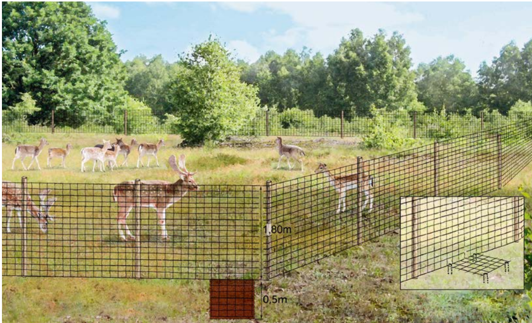
Beispiel für einen Schutzzaun der Haltung von Gehegewild: Um ein Untergraben zu verhindern, werden die Schutzzäune in den Boden eingelassen oder von der Außenseite durch einen Untergrabungsschutz gesichert.
