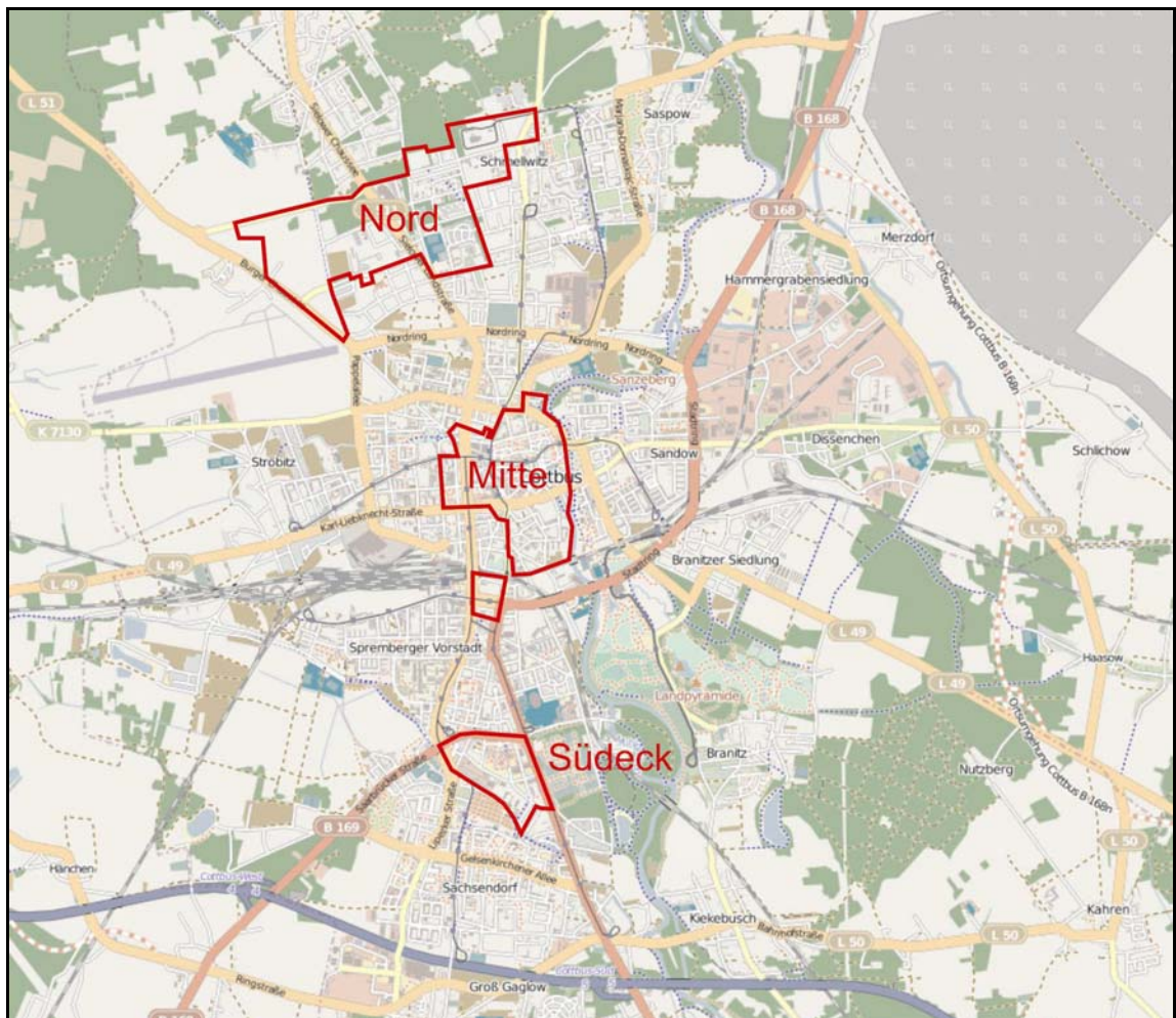
Abb. 16 Übersichtslageplan zu den Fernwärmesetzungsgebieten
