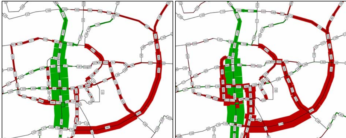
Abbildung 7.11: Sensitivitätsanalyse 2: Kfz-Verkehrslastbilder zum Vergleich der Annahmen „Einbahnstraße“ (links) und „Sperrung“ (rechts) in der Bahnhofstraße in Höhe der Messstation als Differenzdarstellung gegenüber dem Analysefall [ETC 2005]
