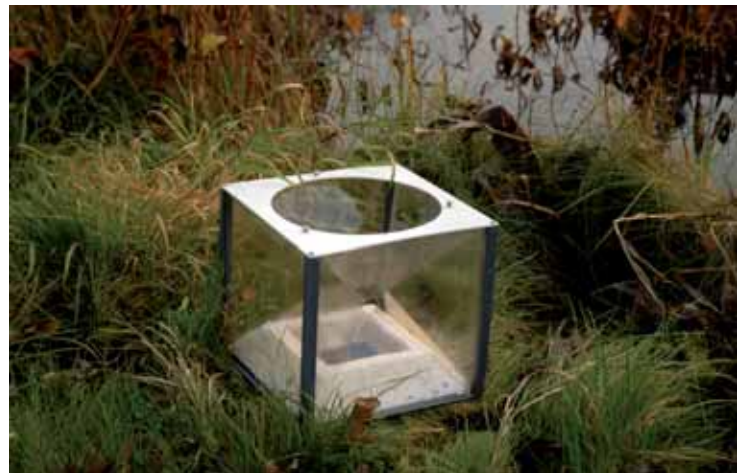
Abb. 110: Spezielle Reuse zum Fang von Amphibienlarven und Molchen. Foto: Norbert Schneeweiß
