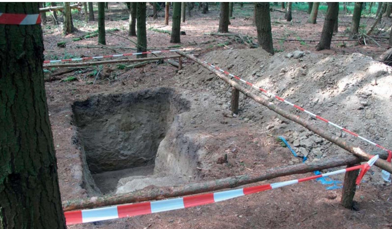
Bild 6: Grube zur Entnahme von Bodenproben
